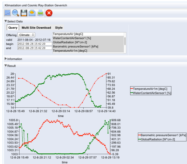
Abbildung 7: Visualisierung von Sensordatenzeitreihen in TEODOOR am Beispiel der Klima- und Cosmic-Ray Station Gevenich im Rureinzugsgebiet.
