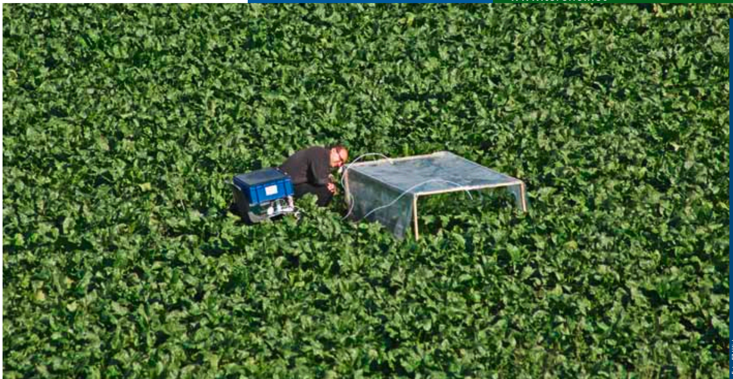
Feldmessungen: Auf unterschiedlichen Ackerflächen ermitteln Jülicher Forscher den Gasaustausch von Pflanzenbeständen
