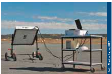
Erfolgreich getestet: Mit einem PLMR-Sensor (l.) können UFZ-Forscher die Bodenfeuchte ermitteln – dank der Verknüpfung mit Vegetationsdaten, die sie mit dem Hyperspektralsensor des Ultraleichtflugzeugs AISA Eagle (r.) erfasst haben
