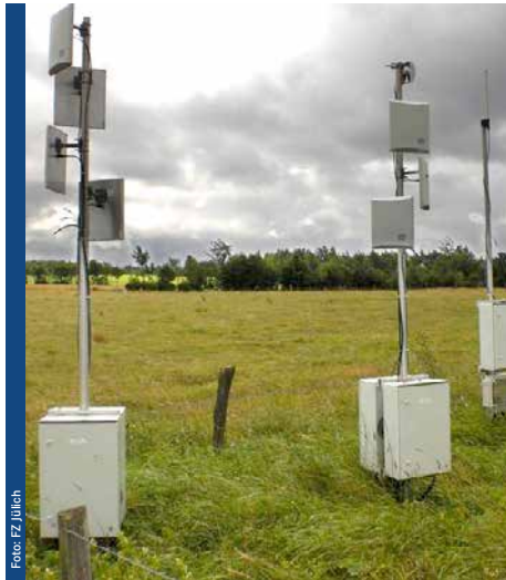
Foto: UFZ Router des Bodenfeuchte-Sensornetzwerks SoilNet am TERENO-Standort Rollesbroich
