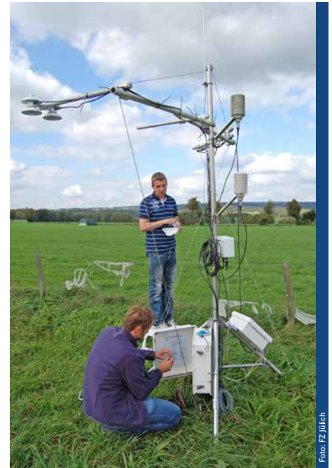
Wichtige Daten: EC-Station am TERENO-Standort Rollesbroich misst latente und sensible Wärmefluss
