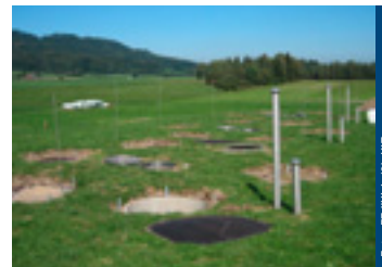
Installation eines Lysimeters: Der nach oben offene Zylinder wird mit Erde aus dem Boden gefüllt (l.). Anschließend heben die Wissenschaftler den gefüllten Lysimeter aus dem Boden, um die Messinstrumente anzubringen (M.). Am Schluss sind außer Belüftungsrohren und Blitzschutzstangen keinerlei oberirdische Bauteile sichtbar (r.)
