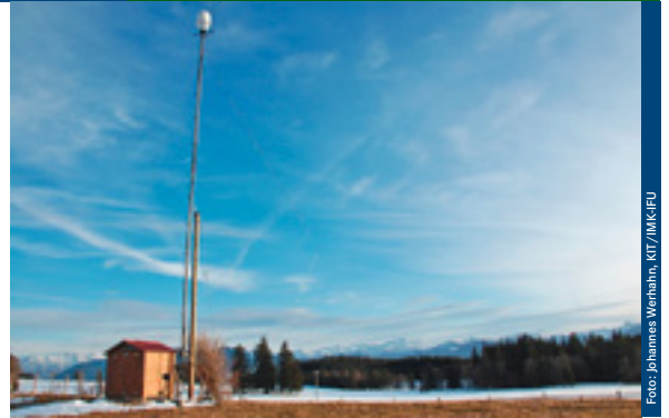
Das Regenradar im Ammer Einzugsgebiet erfasst Niederschlag im Umkreis bis zu 50 Kilometer
