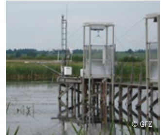
Eddy-Kovarianz-Messsturm und automatische Messkammern im Peenetalmoor
