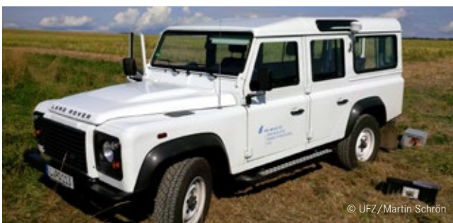
Mit dem TERENO:Rover erstellen Forscher sozusagen im Vorbeifahren hochaufgelöste Karten der Bodenfeuchte.
